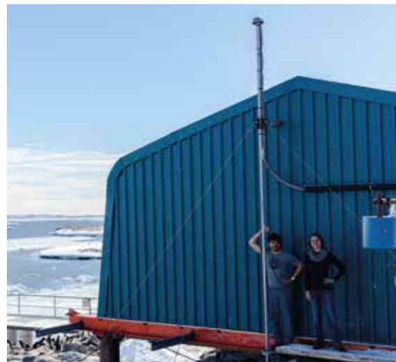
Entrée d'air d'un instrument de mesure utilisé pour l'étude des isotopes - © Leroy Dos Santos
